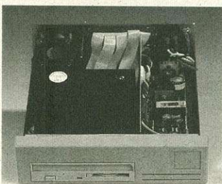
Eingebaut: Alle Kabel sind angeschlossen und das Medium ist montiert
